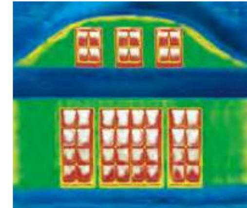
Vor der Renovierung: alte Holzfenster. Deutlicher Wärmeverlust über die Fenster (im Bild: rot).
